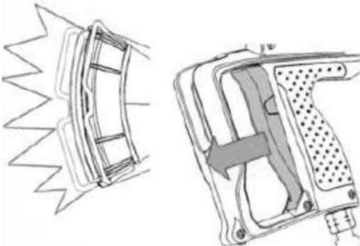
En relâchant la gâchette, la buse de combustion doit s'éteindre instantanément. Sinon :
